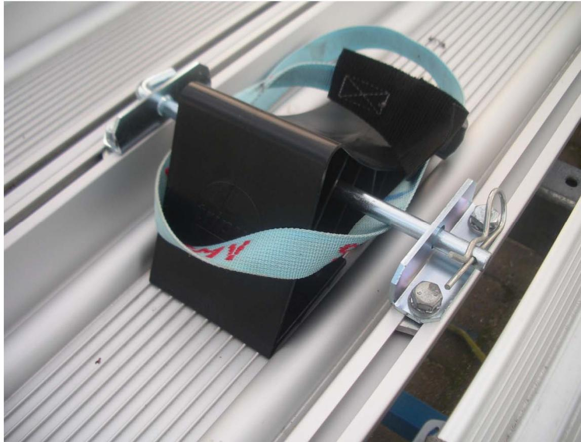
Sichern sie ihr zu transportierendes Fahrzeug immer mit den Spanngurten am Keil wie auf dem Foto. Dabei führen sie den Spanngurt durch die Felge. Zusätzlich muss das Fahrzeug noch mit einem langen Spanngurt am dem Holm an dem der Haltearm befestigt wird mit verzurt werden.
